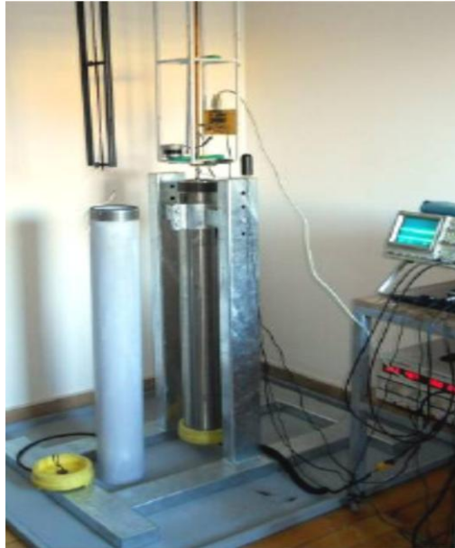
Şekil 2. Hassasiyet ölçümlerinde kullanılan durağan dalga tübü deney düzeneği.
